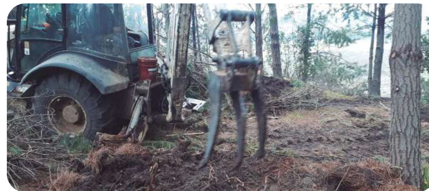
Preparación de casillas con retroexcavadora
