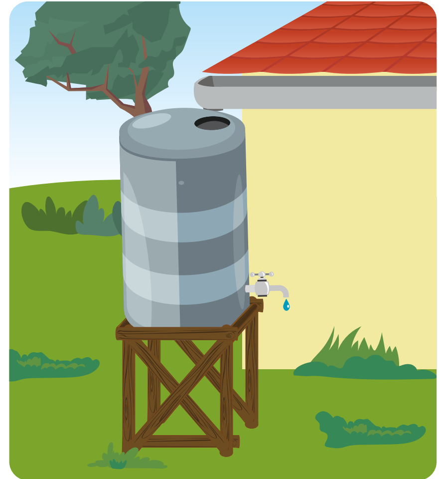
Sistema de colecta de agua lluvia desde techo
