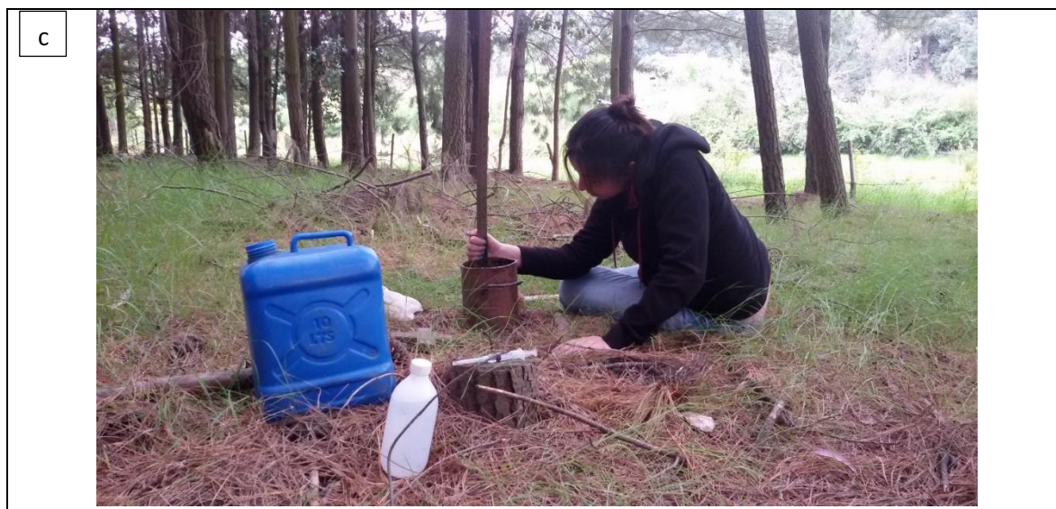
Figura 1.4: Fotos de las pruebas de infiltración: a. Parcela 1 (severidad media alta); b. Parcela 3: severidad baja; c. Parcela de control
